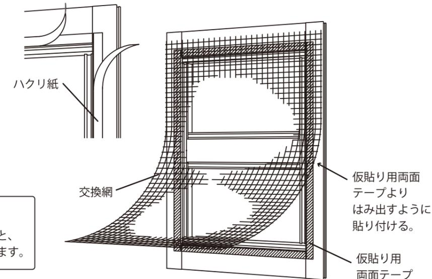
②交換網が全体的にシワなくキレイに張っているか確認し、張っていない部分は、一度テープからはがして、張り具合の調整をして再貼り付けします。
